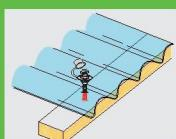
Na strehi privajačimo plošče na vrhu vsakega 3 - 4 valja. Kot smo že omenili morajo biti luknje izvrte za 50% večje od premera vijaka. Zato, da se ob temperaturnih spremembah prosto gibljejo .Razen za Wabe SZ so za druge profilirane Guttagliss plošče podložke obvezni del pritrjevanja (originalni pribor). Na stenskih površinah pritrjujemo Guttagliss prosojne plošče v dnu valja ravno tako vsak 3 do 4 valj.
