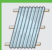
Nosilne letve na katere se pritrujejo plošče naj bodo dimenzije vsaj 40 x 60 mm. Razmak med letvami naj za PVC in Polyester ne presegá 500 mm. Za Akrilne in Makro plošče pa med 500 in 800 mm. Tudi naklon ostrešja naj ne bo manjši od 17%, kajti manjši nakloni ne zagotavljajo vodotesnosti preklopov plošč. Površine, kjer nalegajo prozorne plošče morajo biti obarvane s svetlo barvo in suhe od topil.
