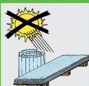
Blago potrebno vedno skladiščiti zaščiteno od direktnega vpliva sonca (nevarenost efekta leče) in vode. Plošče dokler se nahajajo na paleti naj bodo vedno pokrite z neprosojno folijo.
